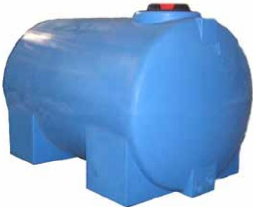
Serbatoio della capacità di 100 o 500 lt a seconda della classificazione di rischio dello stabilimento (par. 10.6.2.3 norma EN12845), costruito in polietilene lineare con la funzione di adescare le pompe quando il gruppo è installato soprabattente. Viene fornito provvisto di raccordi, valvole e tubazioni per consentirne il corretto funzionamento.
